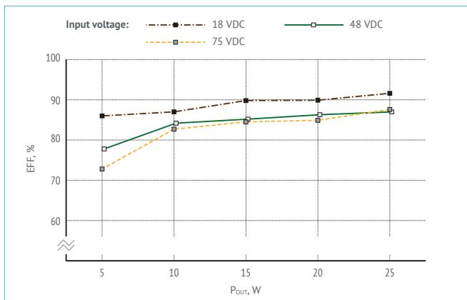
Figure 23. Efficiency of VDRI25W48.
