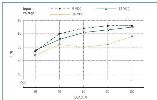
Figure 7 (d). Efficiency of VDR15B12.
