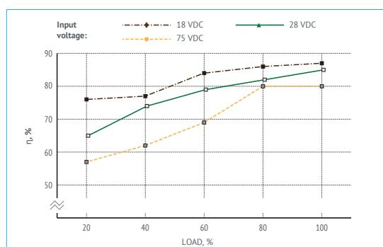
Figure 8 (d). Efficiency of VDR15W12.
