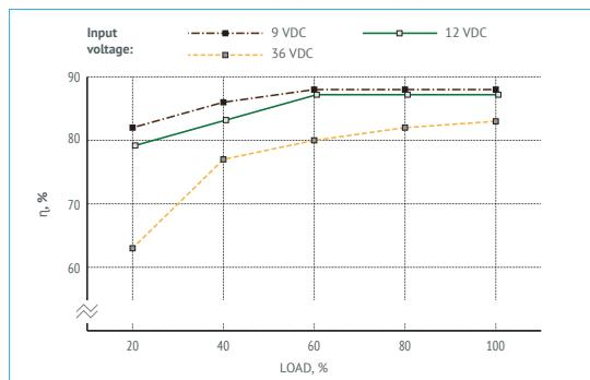
Figure 6 (d). Efficiency of VDR160B24.
