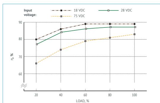
Figure 7 (d). Efficiency of VDR160W24.
