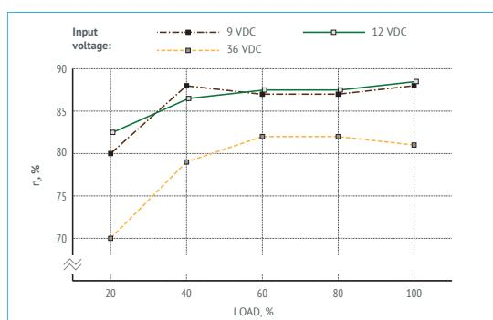
Figure 6 (d). Efficiency of VDR100B15.
