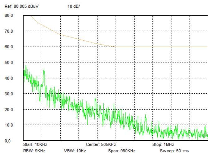
Figure 10 (a). Spectrogram 0,01–1 MHz.
