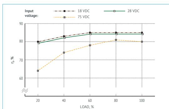
Figure 7 (d). Efficiency of VDR100W24.
